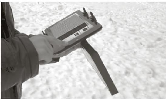
Рис. 8. Опытный образец портативного радара
