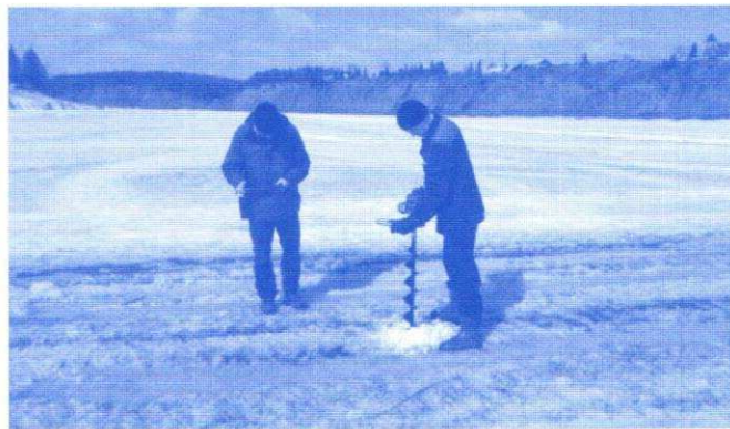
Рис 7. Испытания прибора «Пикор-Лёд» на ледовой переправе (пос. Ванавара Красноярского края)
