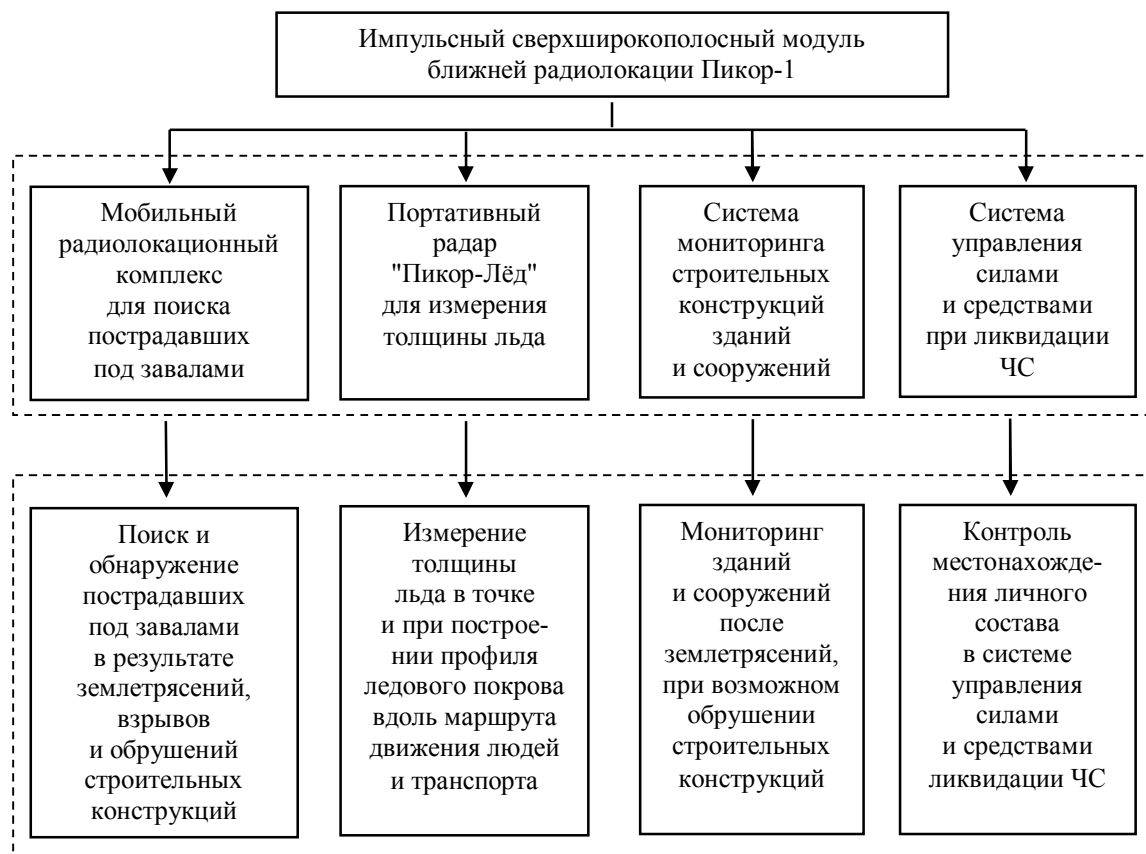
Рис. 3. Сферы применения импульсного СШП-модуля ближней радиолокации Пикор-1
