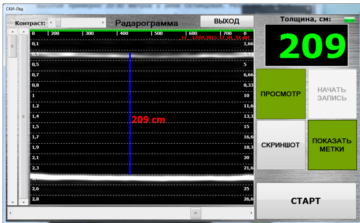
Рисунок 2 – Радарограмма измерения толщины льда.
