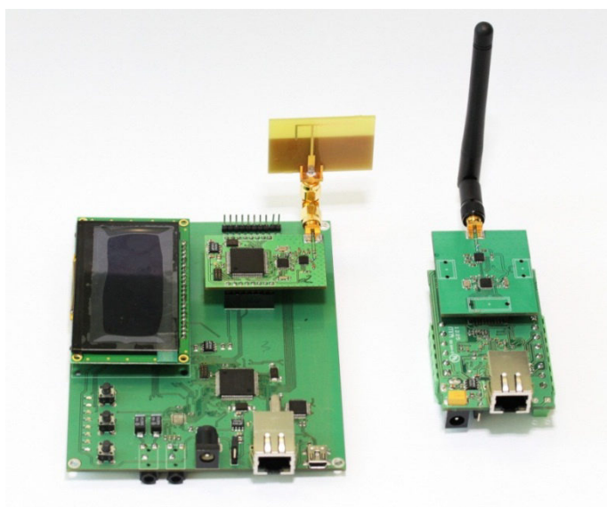
Модуль радиосети с микрополосковой антенной на отладочной плате и модуль шлюза MANET-Ethernet
